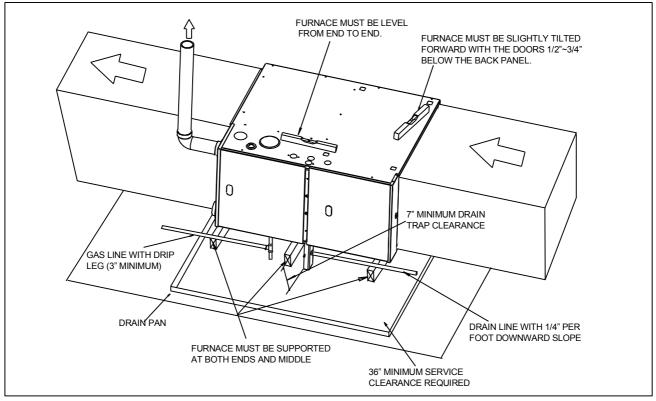
Fig. 9- Horizontal Installationn
