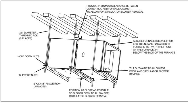
Fig. 8 - Horizontal Installationn
