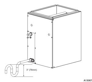
Fig. 8 - Condensate Trap
